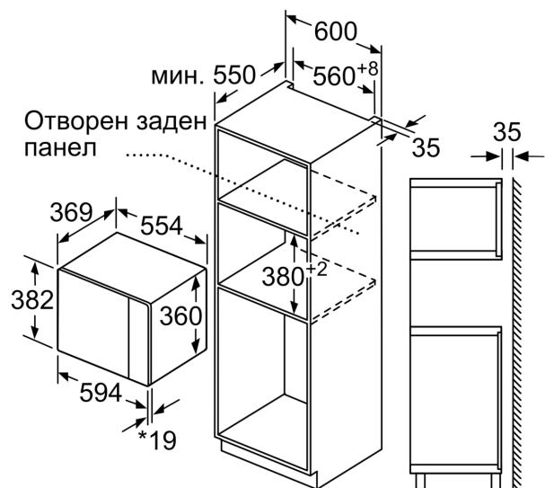
\* 20 мм за метална бленда      Измерване в мм
